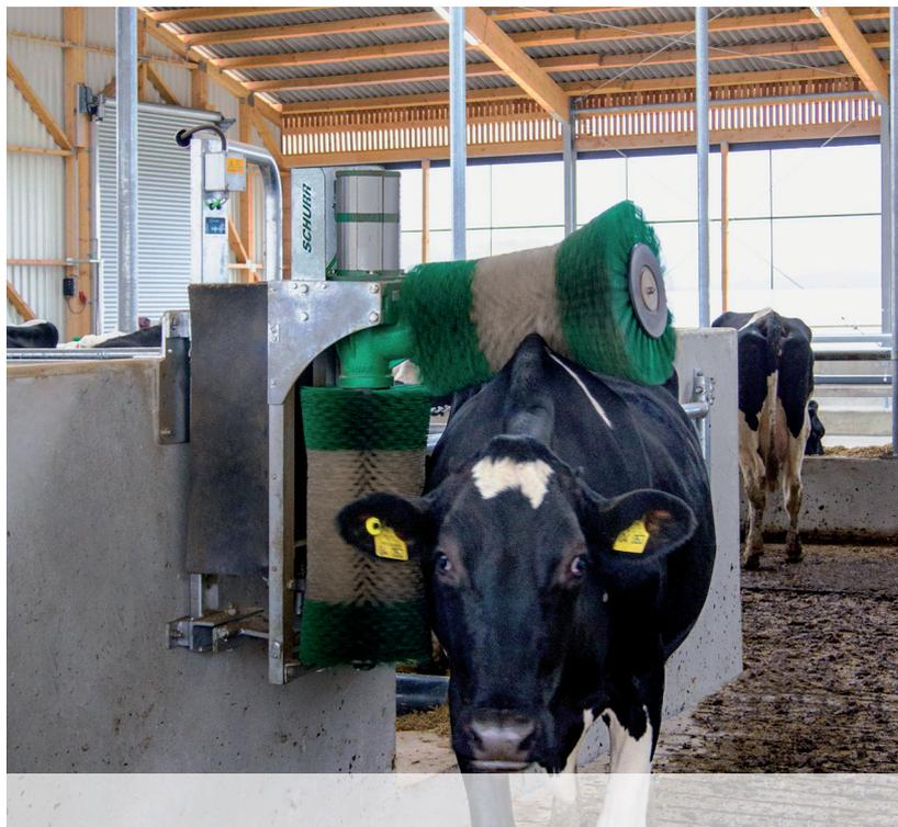
Die Elektrokratzbürste wird an an eine Betonwand oder stabile Holzkonstruktion montiert. Die Montagehöhe richtet sich nach der mittleren Tiergrösse. Achtung: Vor dem Einsatz der der Kratzbürste sind Schwanzhaare der Tiere auf eine Länge von max. 5cm zu kürzen.
