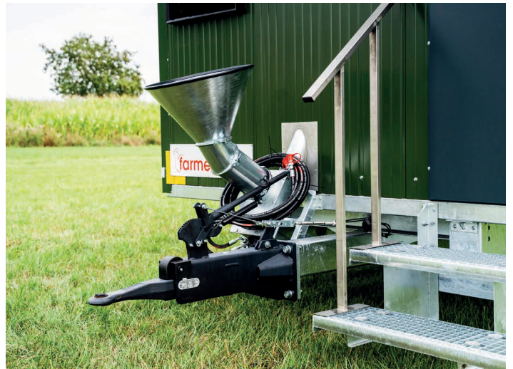
STARTER - plus & STARTER - max: Befülltrichter und auflaufgebremste Zugdeichsel
