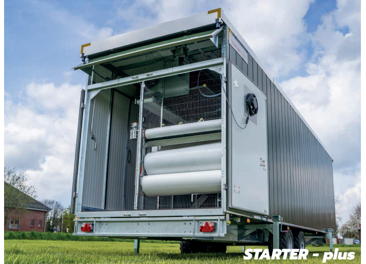
STARTER - plus: zwei elektrisch angetriebene Kotbänder
