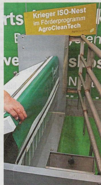
Das wärmedämmte und beheizte ISO-Nest für Abferkelbuchten
