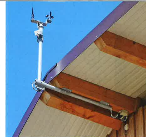
Am Dachfirst messen Sensoren das Licht und den Wind.
