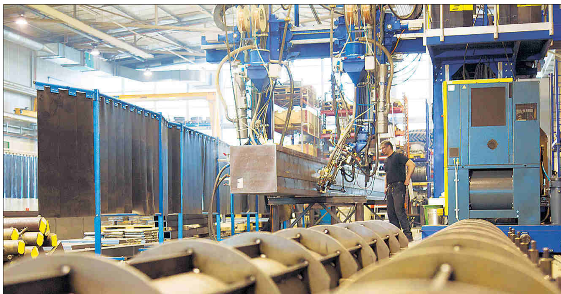
Die Krieger Produktions AG ist von bausinn.ch als vorbildliche Firma nominiert worden, hier einen Blick in die Abteilung Schweisserei. Mit der UP/Time-Schweissanlage können Bauteile bis 2 m x 22 m verarbeitet werden. Fotos zVg
