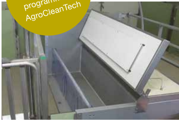
Iso-Nest mit Infrarot Heizelemente
